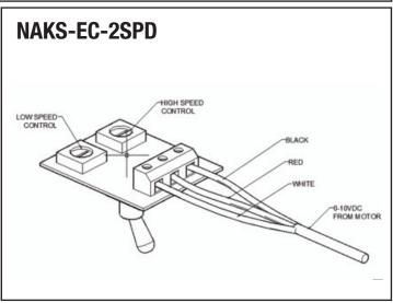
0-10V REMOTE POT DOES NOT DISCONNECT POWER FROM MOTOR ONLY SETS MOTOR TO ZERO RPM
