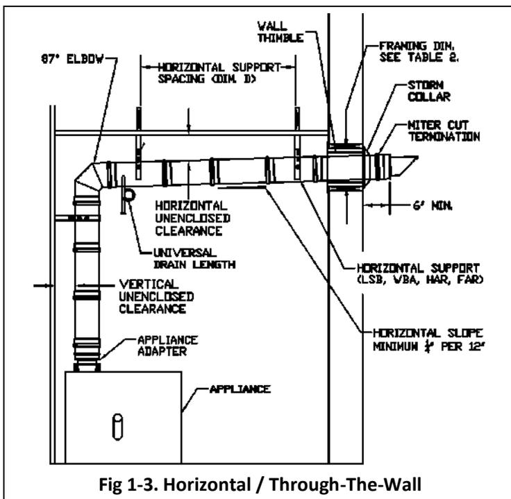
Fig 1-3. Horizontal / Through-The-Wall
